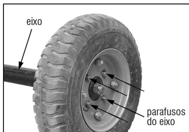
Fig. 2 – Fixação da roda no eixo
