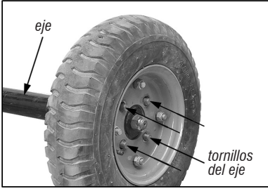
Fig. 2 – Fijación de la rueda en el eje
