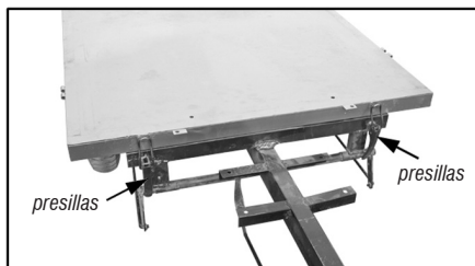
Fig. 12 – Fijación del frente del cucharón
